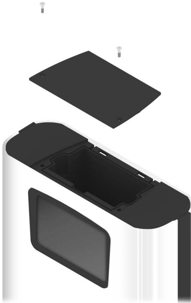
3. Umístěte akumulátor do vnitřního prostoru. Na vnitřní straně systému jsou vygravírovány symboly + a −, které vám usnadní určení správné polohy akumulátoru. Červený pól akumulátoru musí směřovat k symbolu + a černý pól musí směřovat k symbolu −.
