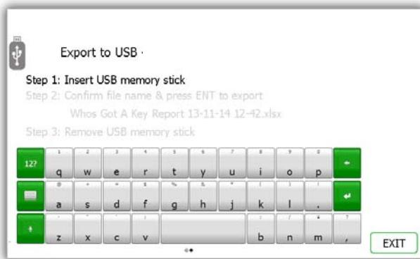
4. Vložte USB flash disk do slotu v systému.
