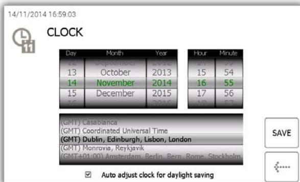
2. Pomocí rolovacích ovládacích prvků nastavte datum a čas. Po dokončení změn uložte nastavení stisknutím tlačítka Save (Uložit).
